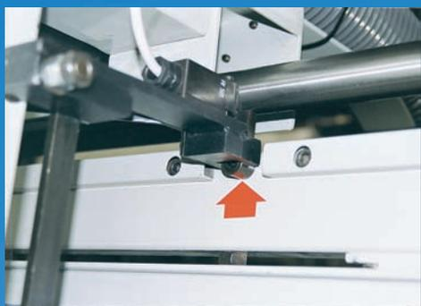
● Bloccaggio trave con micro di sicurezza e dispositivo di innesto obbligato, posizione tagli verticali
