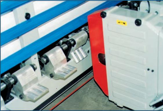
Supporti di alluminio mobili ed a scomparsa, azionati dal programmatore. Permettono di eseguire tagli verticali in ogni punto. Vengono montati in abbinamento al gruppo incisore
