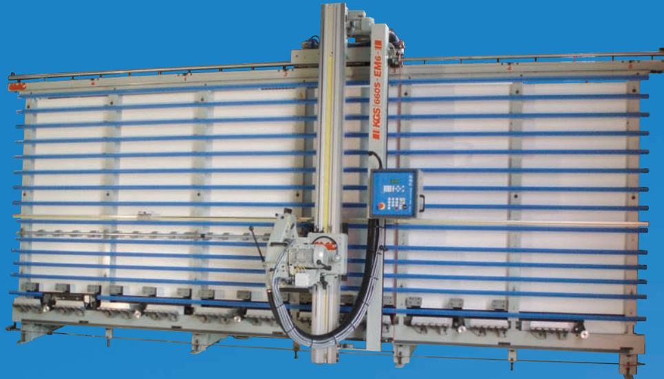
“VSR” è un dispositivo particolarmente adatto al rifilo di pannelli di dimensioni e di peso importanti.
