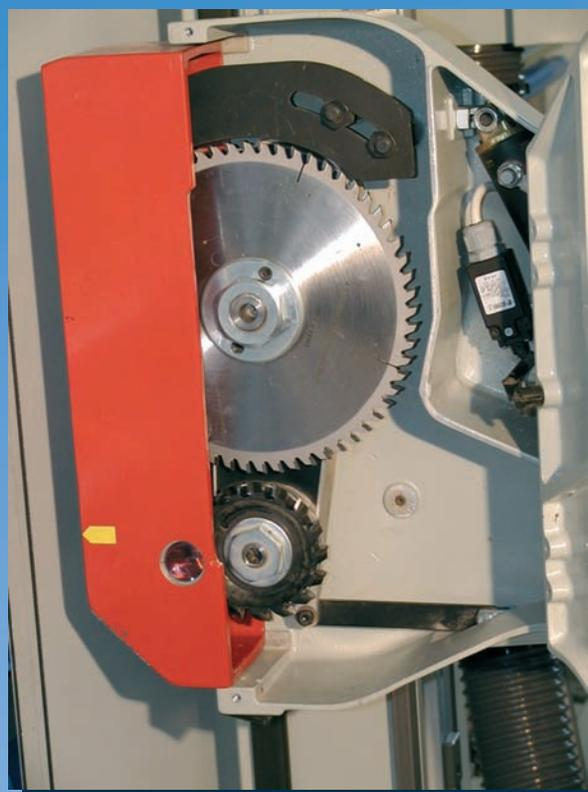
Il dispositivo "SCU" viene azionato tramite un selettore manuale, posto nella parte frontale inferiore del carter (vedi foto 1). Tramite il selettore si sceglie l'utensile che si vuole utilizzare: lama per tagliare, fresa per incidere (nel mod. GMC 170 ES, il selettore è azionato dal programmatore). L'inserimento della fresa per incidere e la sua esclusione avviene tramite un cilindro pneumatico. (vedi foto 2).
