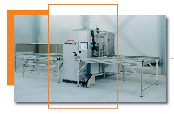
In dem modular aufgebauten Bearbeitungszentrum wurden alle wichtigen Komponenten, wie Steuerung, Bedienerführung via Monitor, Scanner sowie Zu- und Austransportpuffer übersichtlich angeordnet. Der von allen Seiten zugängliche Aufbau des Profilbearbeitungszentrums PBZ gewährleistet einen schnellen Werkzeugwechsel, einfache Wartung und Instandhaltung.
