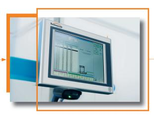
Auflegen und Abnehmen – der Profiltransport erfolgt automatisch über Zufuhrmagazin und Austransportpuffer – und Auswählen der Profildaten über einen Scanner ist die einzig verbleibende Tätigkeit. Die Profilidentifikation gewährleistet die exakte Ausführung der festgelegten Bearbeitungsschritte. Die Geschwindigkeit der Bearbeitungsschritte ist individuell einstellbar.
