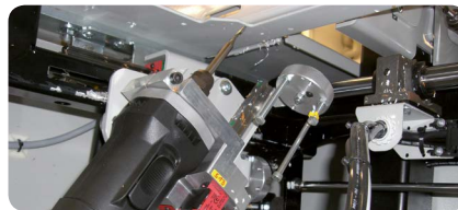
Bohr-/Fräsaggregat von unten mit Winkelverstellung 0 - 65°
