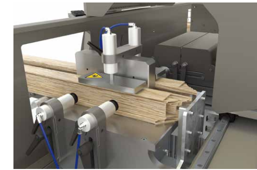
GRUPPO MORSA INTESTATURA TRAVERSO CLAMP UNIT FOR TRANSOM END MILLING
