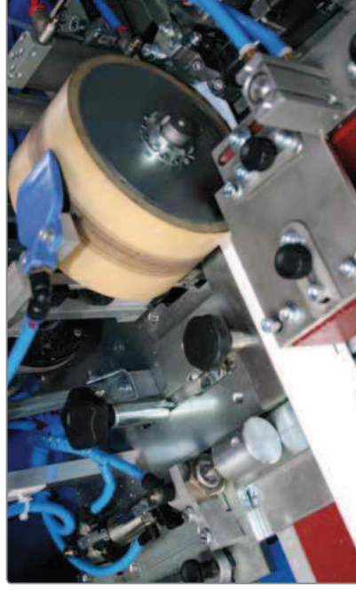
Der Einzug und die Arretierung der Profile erfolgt automatisch.
