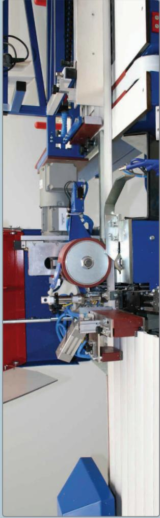
Antreibsrad mit PU-Beschichtung für einen materialschonenden Transport der Profile.
