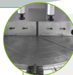
Manuelle Zwischenwinkleinstellung nach Skala, klemmbar
