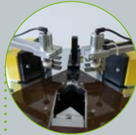
2 Zylinder spannen das Profil plan auf die Auflage, 3 Satz Pressmesser
