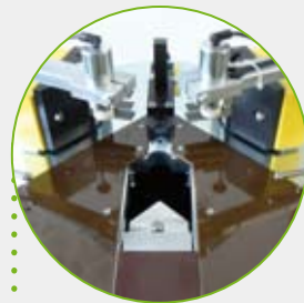
Widerlager versenkt, freie Arbeitsfläche
